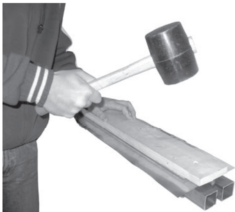
Sl: Savijanje limenih krilca
